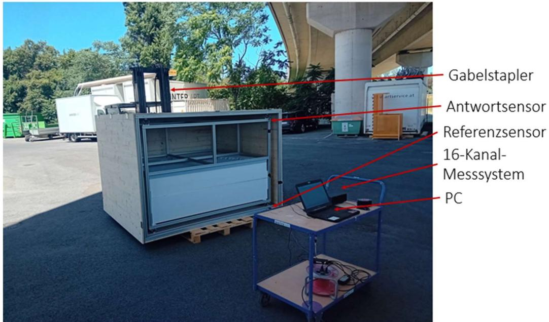
Abb. 5: Schwingungsoptimierte Schutzverpackung für den „Federkopfschmuck“ beim Hardwaretest
